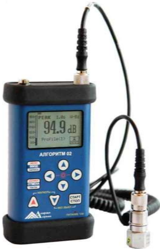
Рис 67. Вибромеры ИЦ «Сейсмофонд» работающий совместно с программным комплексом АВAGUS (UCA) для лабораторных испытаний фрагментов и узлов КФ со свинцооой поглощающей сейсмическую энергию прокладкой Коваленко А И
