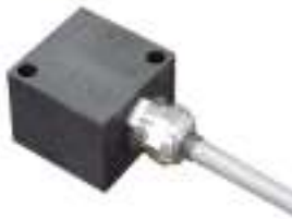
Рис 61. Акселерометр работающий совместно с программным комплексом АВAGUS (UCA) для лабораторных испытаний фрагментов и узлов КФ со свинцооой поглощающей сейсмическую энергию прокладкой Коваленко А И
