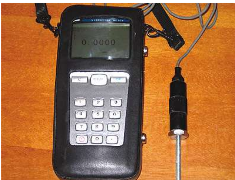
Рис 66. Вибромеры ИЦ «Сейсмофьюнд» работающий совместно с программным комплексом АВAGUS (UCA) для лабораторных испытаний фрагментов и узлов КФ со свинцооой поглощающей сейсмическую энергию прокладкой Коваленко А И
