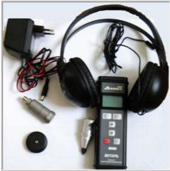
Рис 63. Вибромеры ИЦ «Сейсмофонд» работающий совместно с программным комплексом АВАGUS ( USA ) для лабораторных испытаний фрагментов и узлов КФ со свинцоой поглощающей сейсмическую энергию прокладкой Коваленко А И
